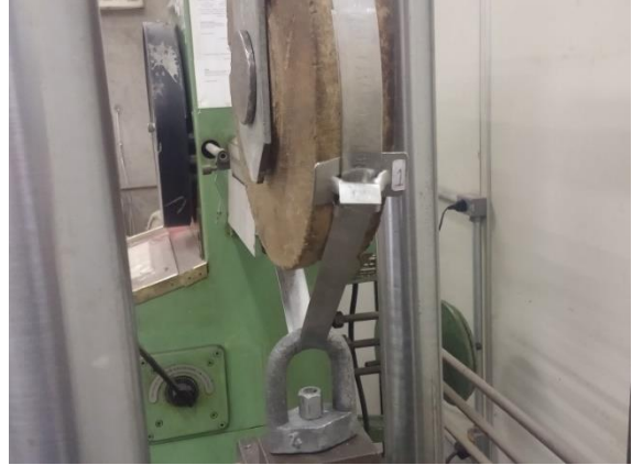
Foto 08 – Amostra apresentada após teste de tração
